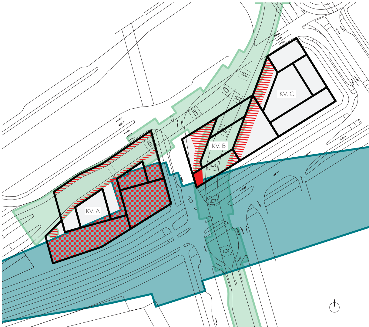
Fig. 3 Grundläggningsområden för Västlänken och Hisingsbron, och områden kritiska för grundläggning av kvarter.
